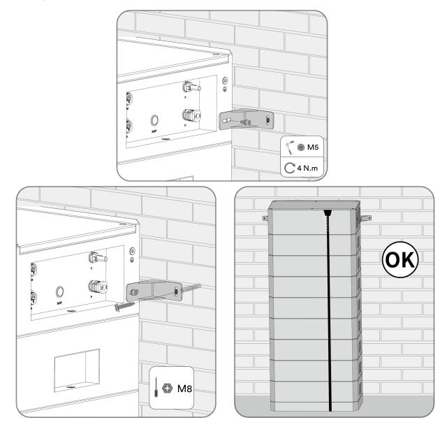
**Step 10:** Secure the hanger using screws(M8×40).
